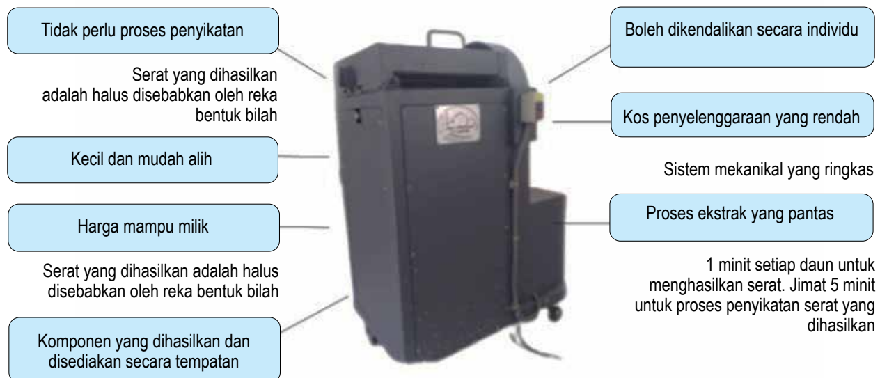
Rajah 7 Penerangan mesin pengekstrakan gentian daun nanas
