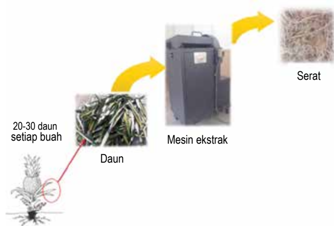
Rajah 8 Carta aliran pengekstrakan gentian daun nanas
